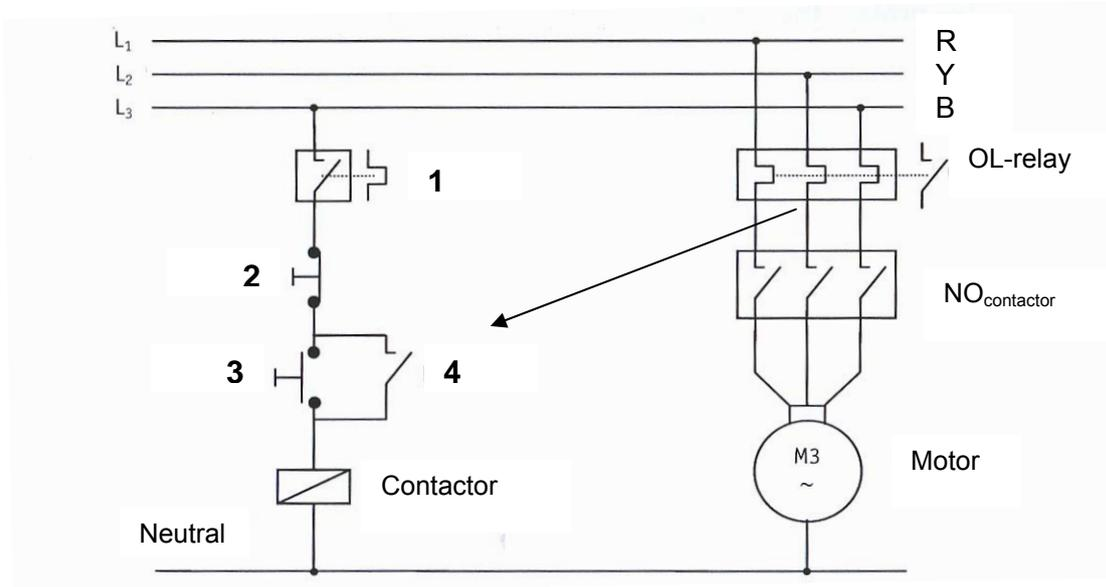
**FIGURE 10.2: DIRECT-ON-LINE MOTOR STARTER**
