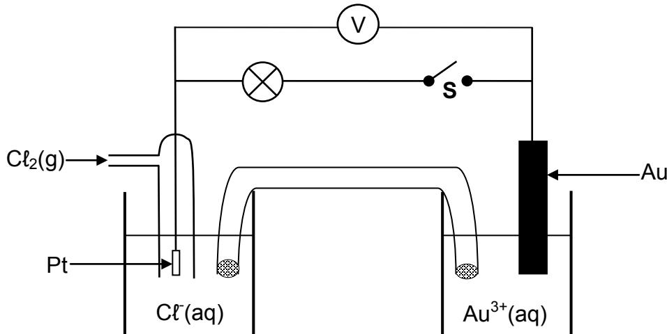
Met skakelaar **S** OOP is die aanvanklike lesing op die voltmeter 0,14 V.
