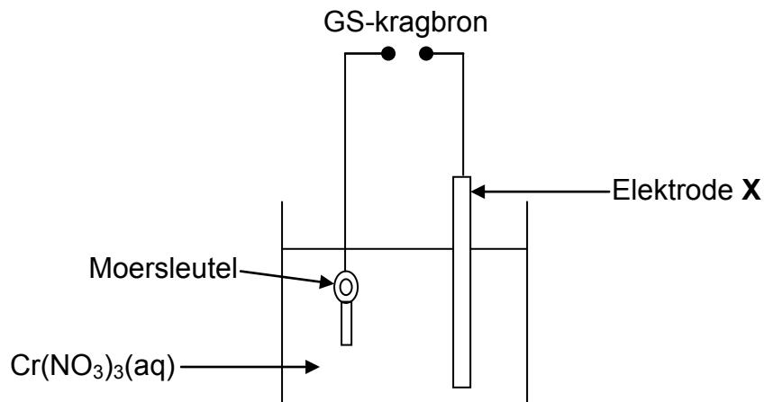
'n Konstante stroom gaan deur die oplossing en die konsentrasie van  $\text{Cr}(\text{NO}_3)_3\text{(aq)}$  bly konstant tydens die proses. In die proses word 'n totaal van 0,03 mol elektrone in die elektrolitiese sel oorgedra.
