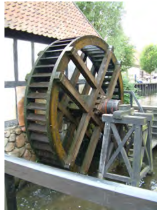
'n Waterwiel gebruik die vloeï van die water om die wiel in die rondte te stoot, wat dan die werk kan doen.
